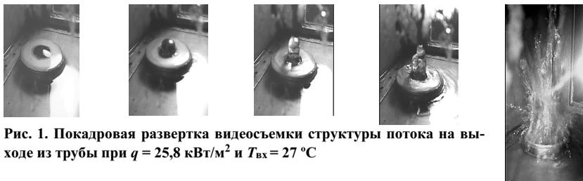
Рис. 1. Покадровая развертка видеосъемки структуры потока на выходе из трубы при  $q = 25,8$  кВт/м<sup>2</sup> и  $T_{вх} = 27$  °С
