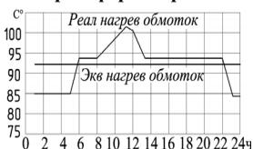
Рис. 2. График температуры нагрева обмотки при загрузке его полной мощностью
