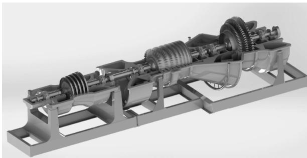
Рис. 1. ГТУ с турбодетандерным приводом компрессора
