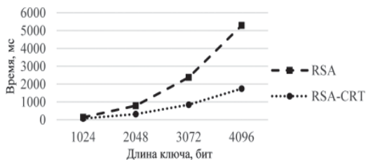
Рис. 1. Время выполнения дешифрации для алгоритмов RSA и RSA-CRT
