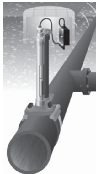
Рис. 1. Система мониторинга температуры на трубопроводе
