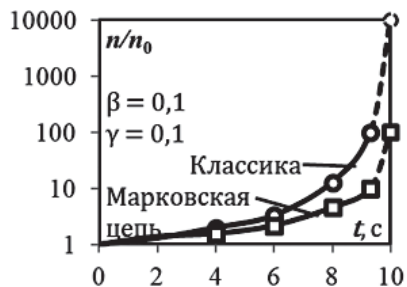
Рис. 1. Отклики реактора на ввод линейной реактивности
