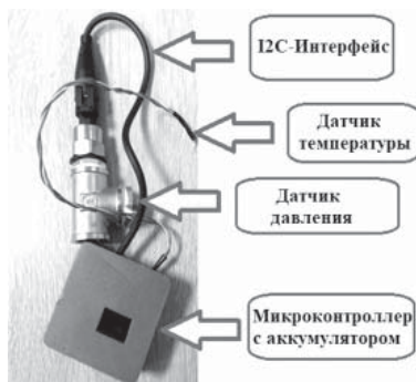
Рис. 1. Беспроводной датчик контроля дегазации
