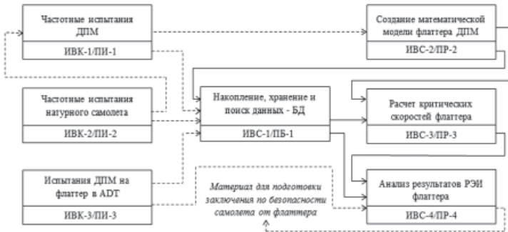
Рис. 1. Структура обобщенной модели исследований флаттера
