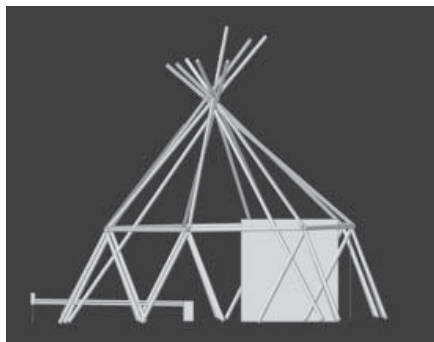
Рис. 2. Расположение термоэлектрогенератора в яранге и конструкция яранги
