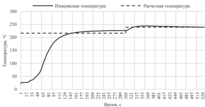
Рис. 1. Результат работы прототипа цифрового двойника микро-ГТУ
