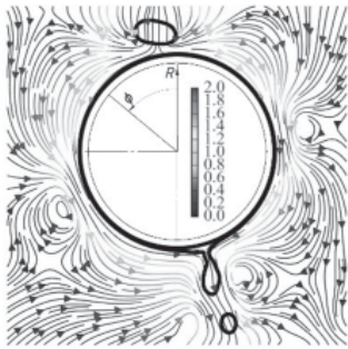
Рис. 1. Момент падения на цилиндр и отрыва капли конденсата при орошении с расходом 5G_{Nu}
