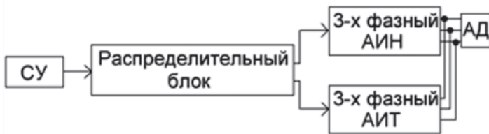
Рис. 1. Блок-схема управления асинхронным двигателем с использованием АИТ и АИН
