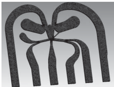
Рис. 1. Неструктурированная тетраэдральная сетка проточной части струйного элемента
