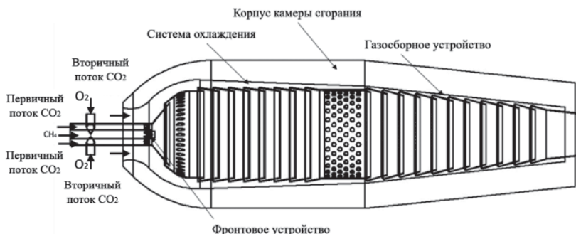
Рис. 1. Эскиз кислородно-топливной камеры сгорания с углекислотным разбавителем
