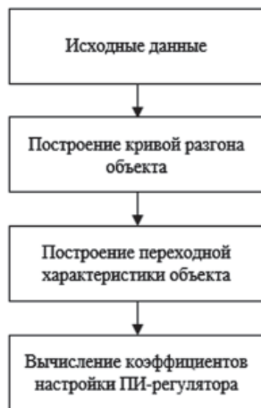
Рис. 1. Структурная схема алгоритма вычисления коэффициентов в ПИ-регуляторах
