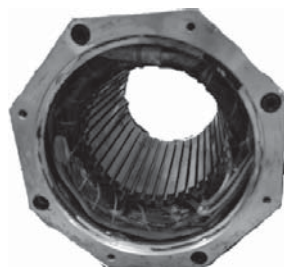
Рис. 3. Статор СМПИМ компании Fanuc
