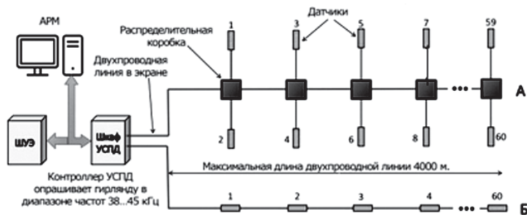
Рис. 1. Система электрического обогрева на основе пьезорезонансных датчиков
