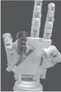
Рис. 1. Конструкция бионического протеза руки
