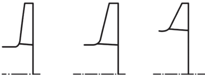
Рис. 1. Схема расширения входа рабочего колеса центробежного насоса
