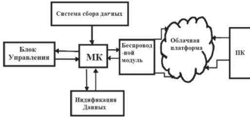
**Рис. 1.** Структурная схема холтера с облачной обработкой данных
