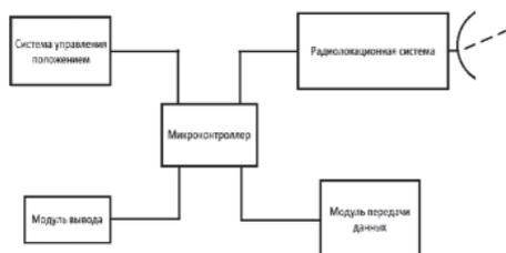
Рис. 1. Структурная схема мобильной РЛС
