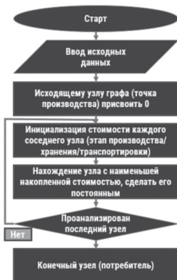
**Рис. 1.** Алгоритм оптимизации цепочек поставки водорода
