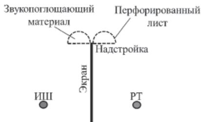
Рис. 1. Схема экрана с надстройкой
