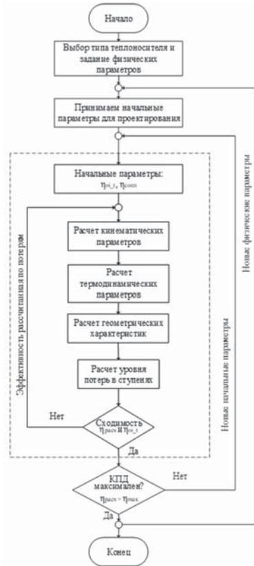
Рис. 1. Алгоритм выбора конструкций турбин
