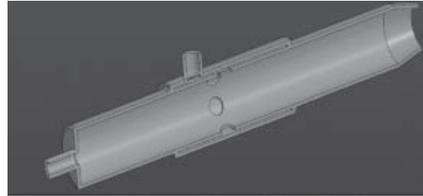
**Рис. 1.** Спроектированная запальная горелка
