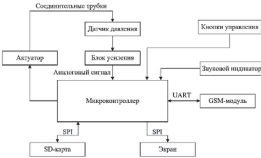
Рис. 1. Структурная схема тонометра с модулем GSM
