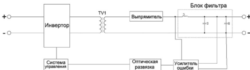
Рис. 1. Блок-схема работы преобразователя
