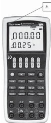
Рис. 1. Общий вид калибратора модели АКІП-73023
