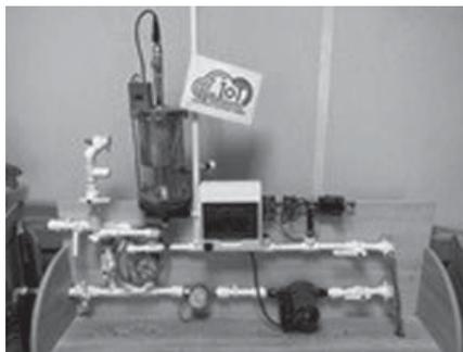
**Рис. 1.** Прототип системы теплоснабжения
