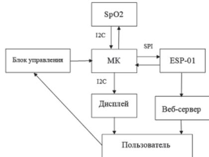
**Рис. 1.** Структурная схема беспроводного датчика удаленного мониторинга SpO<sub>2</sub>
