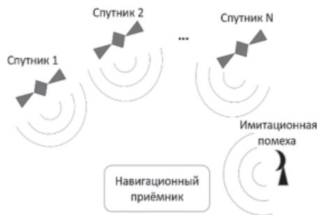
**Рис. 1.** Схема работы приёмника в условиях воздействия помехи
