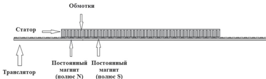
Рис. 1. Двумерный осесимметричный вид линейного генератора
