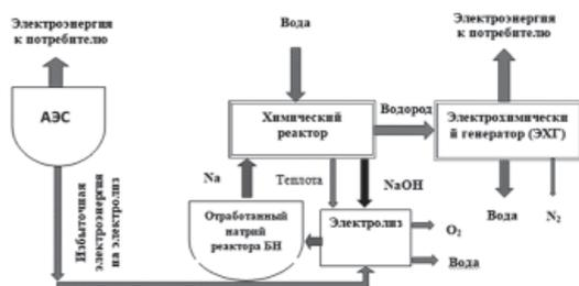
Рис. 1. Технологическая схема использования отработанного натрия реактора БН
