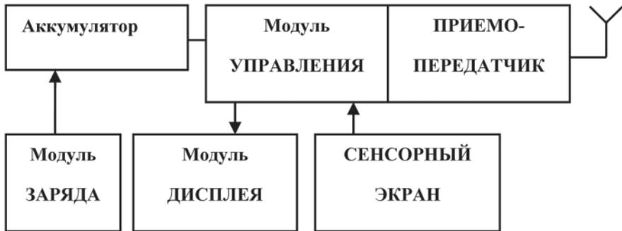
**Рис. 1.** Функциональная схема имитатора
