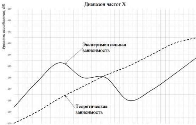
Рис. 2. Зависимость уровня ослабления от частоты
