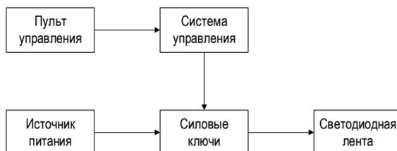
**Рис. 1.** Структурная схема светодиодной подсветки
