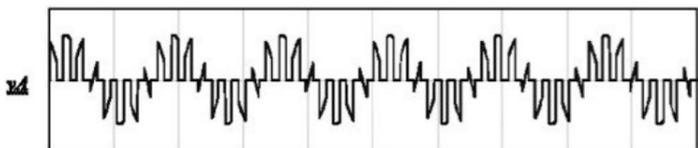
Рис. 2. Кривая выходного напряжения
