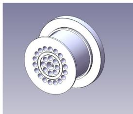
Рис. 1 Трехмерная модель коллекторного узла прибора
