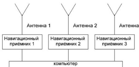
**Рис. 1. Стандартная схема, используемая для фазовых измерений**
