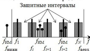
Рис. 1. Расположение спектров полезных сигналов и ИМ помех в полосе частот ствола РТР
