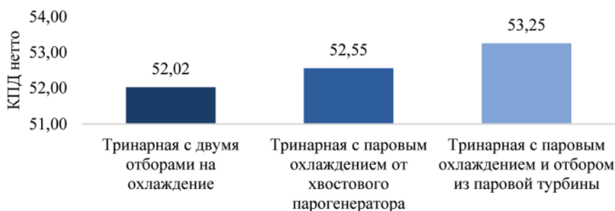
Рис. 1. Сравнение влияния различных способов охлаждения газовой турбины на энергоэффективность тринарной энергоустановки
