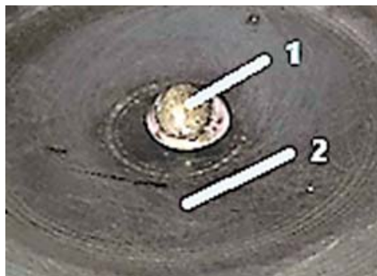
Рис. 1. Модель градины (1 — твердая сфера, покрытая слоем жидкости, 2 — нагретая поверхность)
