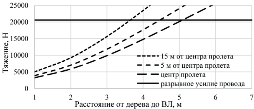
Рис. 1. Зависимость нагрузки, создаваемой падающим деревом, в разных местах пролёта, в зависимости от расстояния до ВЛ
