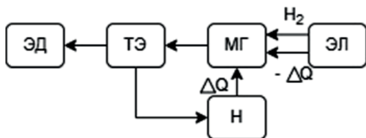
Рис. 1. Принцип работы водородного велосипеда (ЭЛ — электролизер, МГ — емкость с металлогидридом, ТЭ — топливный элемент, Н — нагреватель, ЭД — электродвигатель)
