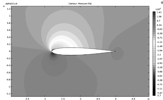
Рис. 1. Распределение поля давления профиля лопасти вертикально-осевой ВЭУ
