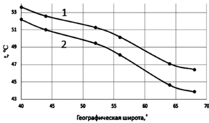
Рис. 1. Зависимость температур кузова (1) и салона (2) от географической широты
