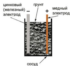
Рис. 1. Схема установки на основе электрохимической энергии почвы
