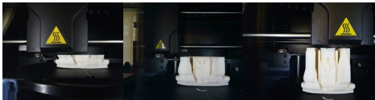
Рис. 1. Процесс печати модели регулирующего клапана
