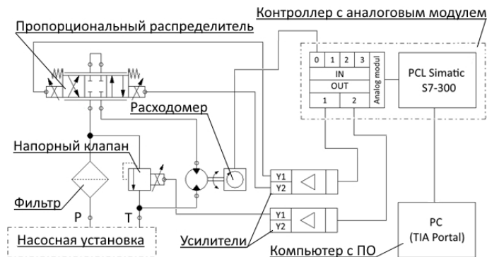
Рис. 1. Электрогидравлическая схема экспериментального стенда
