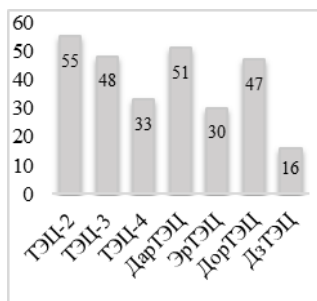
Рис. 1. Срок эксплуатации оборудования различных ТЭЦ энергосистемы Монголии
