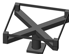
Рис. 1. Конструктивная схема микромеханического гироскопа с резонатором в виде упругих стержней
