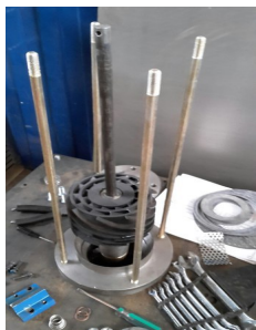
Рис. 1. Пилотный образец полирядного конденсатного насоса в процессе сборки
