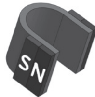
Рис. 2. Дугогасительная система с постоянными магнитами и немагнитной скобой
