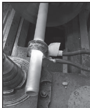
Рис. 2. Фото процесса оплавления покрытия с помощью индукционного нагрева
