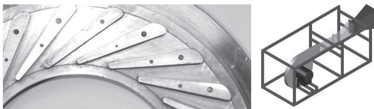
Рис. 1 (слева)Диффузор с клиновидными лопатками реального центробежного компрессора ЗГТУ; (справа) модель экспериментального стенда
