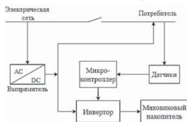
Рис. 1. Структурная схема системы с маховиковым накопителем
