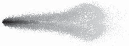
Рис. 2. Струя изооктана в сносящем потоке скоростью 30 м/с при давлении впрыска 100 бар по результатам OpenFOAM — вид сверху
