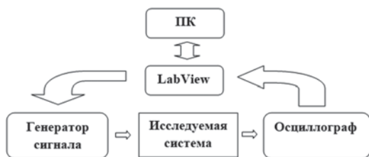
Рис. 1. Структурная схема автоматизированной системы
