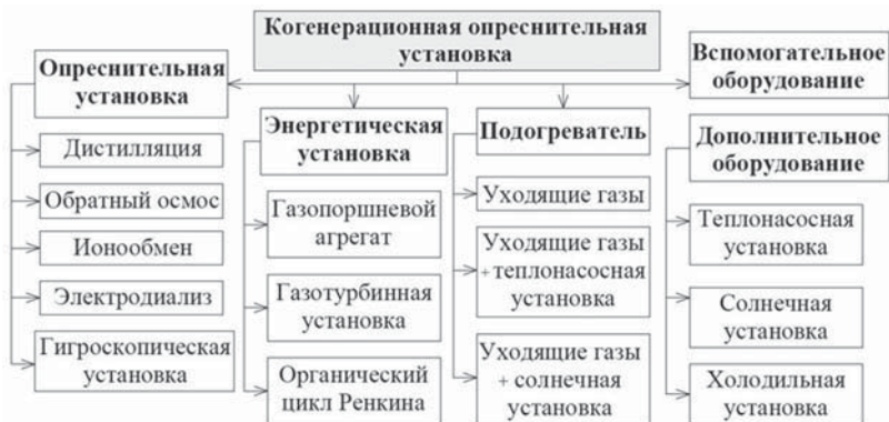
Рис. 1. Дерево вариантов когенерационной опреснительной установки
