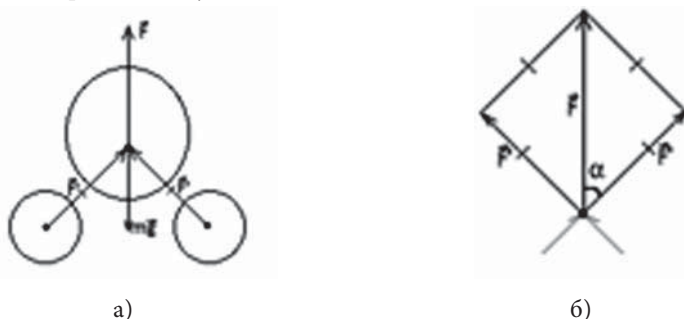
Рис. 1. Принимаемая модель: а) схема взаимодействия капли со струнами; б) направления векторов сил, поддерживающих каплю в левитирующем положении
