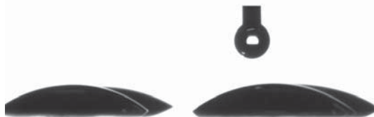
Рис. 1. Коллектив капель дистиллированной воды на стеклянной подложке
