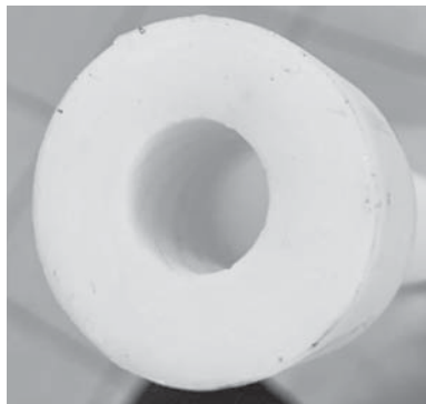
Рис. 1. Фотография пластиковой трубы со спиральной навивкой
