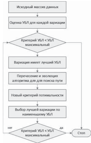
Рис. 1. Блок-схема генетического алгоритма синтеза неперидических антенных решеток
