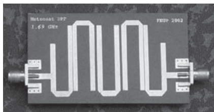
Рис. 1. Пример реализации микрополосковых СВЧ фильтров и делителя мощности
