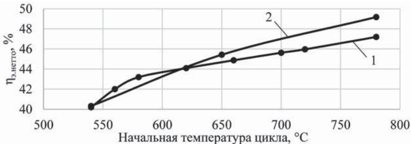
Рис. 1. Зависимости КПД нетто циклов от температуры рабочей среды на входе в голову турбины: 1 — паротурбинный цикл, 2 — углекислотный цикл
