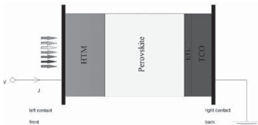
Рис. 1. Структура моделируемого перовскитного солнечного элемента: HTM — \text{spiro-OMeTAD} , Perovskite — \text{CH}_3\text{NH}_3\text{SnI}_3 , ETL — \text{TiO}_2 , TCO — токопроводящий слой
